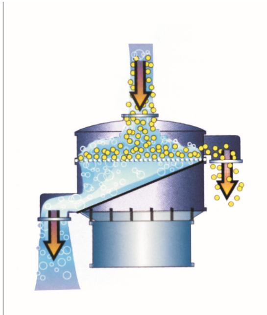
振动筛是一款应用很多的机械设备。可用于化工、医药、食品、金属冶金、建材、陶瓷灯行业。那么您知道振动筛是怎么产生震动的么？想提高振动筛频率时我们又该如何做呢？下面余盈振动筛就为您一一解答。首先我们要知道振动筛的震动是通过振动电机将电能转换为机械能。但您知道振动筛的震动形式是分两种的。一种是三维圆形震动，另一种是上下直线震动。三维圆形震动，这种震动方式主要是出现在精细振动筛上。该系列筛机是由底座种的立式振动电机作为主要振动源，通过电机带动筛箱进行运动。由于立式振动电机运行方式是圆周运动，所以筛框的震动方式为三维运动。该震动方式优势在于仿人工筛分原来，对精细的颗粒状、粉末状物料有良好的筛分效果。但由于电机功率过小，所以激振力过小，产量不大。该震动方式机型有□XFC超声波振动筛□XF三次元振动筛□YBS摇摆筛等。超声波电源，持续工作周期多久？厂家保修吗？浙江振动筛优惠报价
